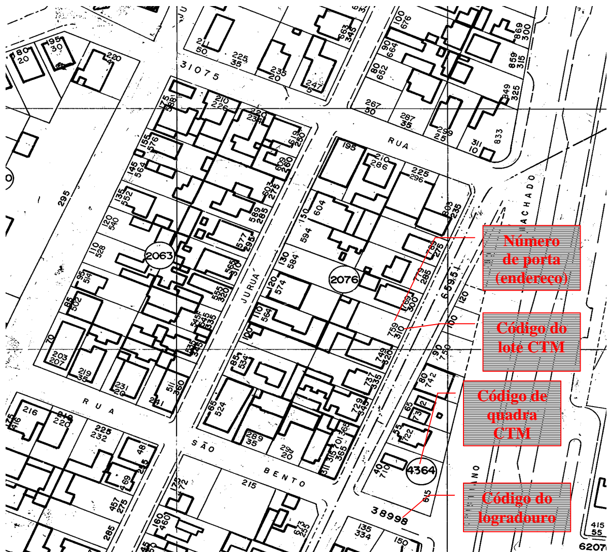
Figura 6 – Ilustração de parte de uma planta de edificações elaborada pelo CTM na escala 1:1.000. O código do lote CTM é definido a partir de medidas métricas, iniciadas no extremo da quadra denominado ponto zero, seguindo o sentido de rotação do relógio, até aproximadamente o meio da testada de cada lote da quadra até completar o perímetro da quadra. O código sempre termina em zero ou em cinco.
